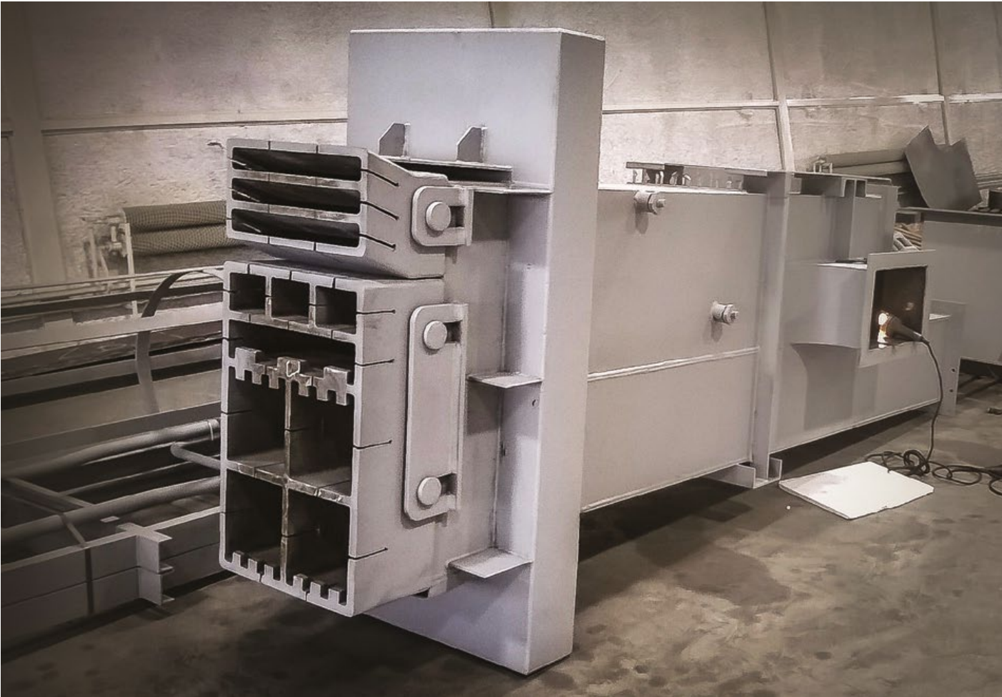
↑ Litá ústí proudového hořáku
