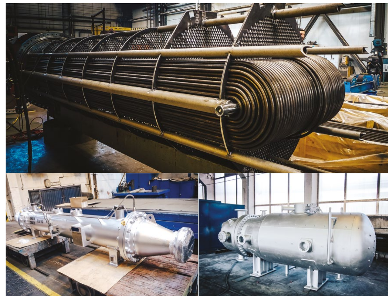
↑ Fotodokumentace realizace tepelných výměníků
