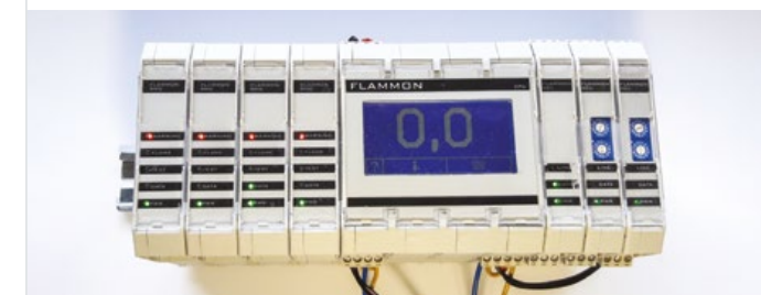
↑ Moduly procesorů jednotlivých optických snímačů a centrálního procesoru
