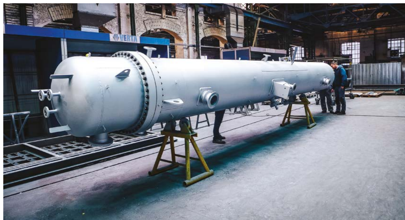
↑ Тепловой подогреватель низкого давления
