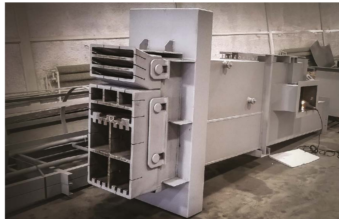
↑ Литые устья прямоточных горелок
