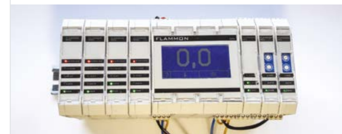
↑ Модули процессоров отдельных оптических датчиков и центрального процессора
