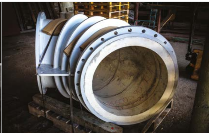
↑ Трубопровод для отработанного пара с каркоровой вставкой
