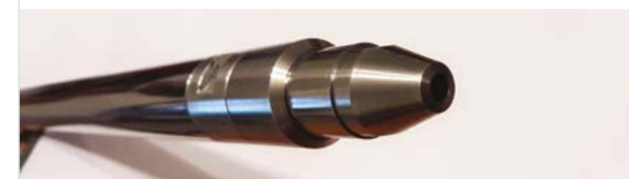
↑ Оптический сенсор требует только 15 мм зазор к камере сгорания
